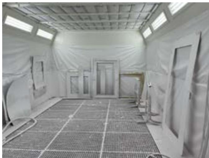
*Figure 5 - Cabine de pulvérisation avec aspiration par le bas et soufflage par le haut*
