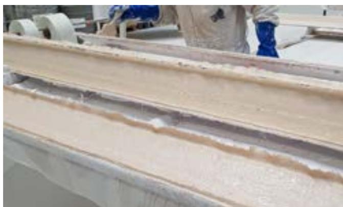
Figure 1 - Fabrication de pièces en polyester armé par moulage au contact
