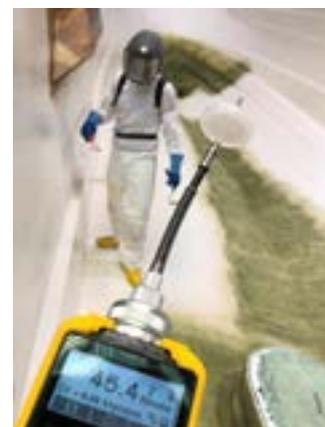
Figure 3 - mesures dynamiques de styrène avec détecteur pid lors de la fabrication d'une coque de bateau
