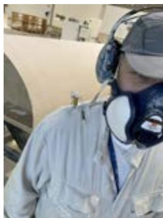
Figure 2 - Mesure de COV sur opérateur
