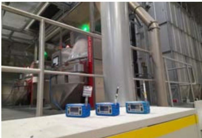
*Figure 4 - Pompes bas débit avec supports pour la mesure d'acide acétique, COV et formaldéhyde dans l'air d'un atelier d'extrusion du PET recyclé*
