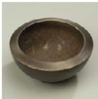
Figure 1 : Photo d'une coquille brut de forgeage. [Cb Monaco]
