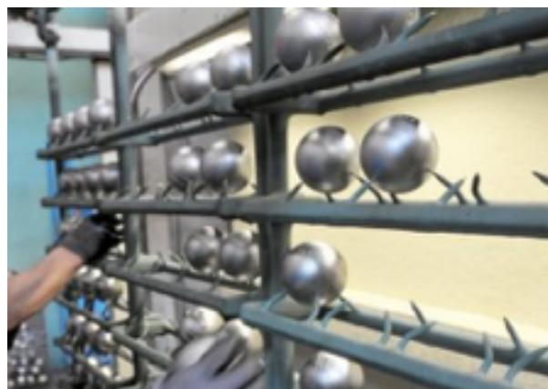
Figure 10 : Support en vue des traitements de surface. [Obut 14-15]
