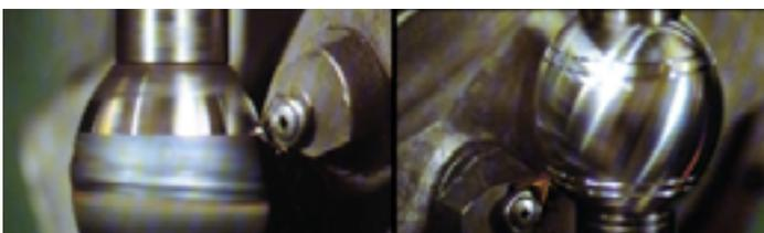
Figure 9 : Illustration des opérations de tournage et striage. [Cb pyrénéens]
