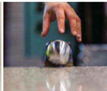
Figure 2 : Passage au marbre : test d'équilibrage. [Obut 14-15]
